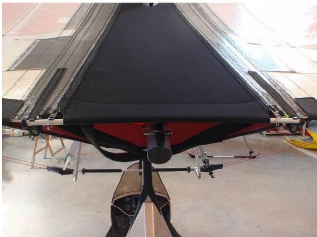
15. Refermer les fermetures à glissière de la jonction centrale en néoprène. Mettre la latte de tension de bord de fuite en position dans les supports à l'extrémité des lattes centrales en exerçant une traction vers l'arrière (Figure 5-4).
